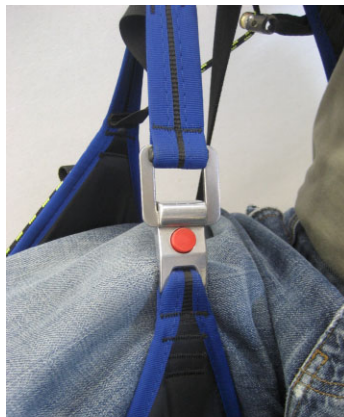
Die korrekt verschlossene Beinschlaufenschließe
