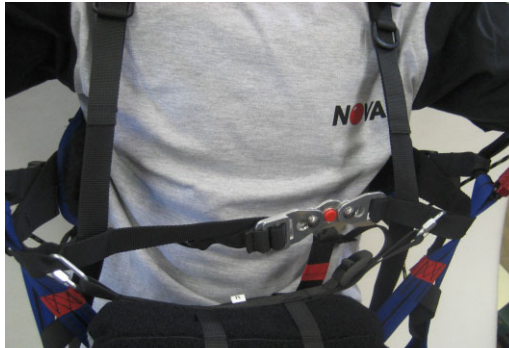
Befestigung des Frontcontainers mittels Schraubkettenglieder
