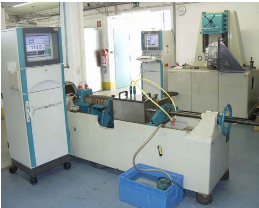
Bild 5: Foto des Resonanzprüfstandes für die vergleichende Prüfung
