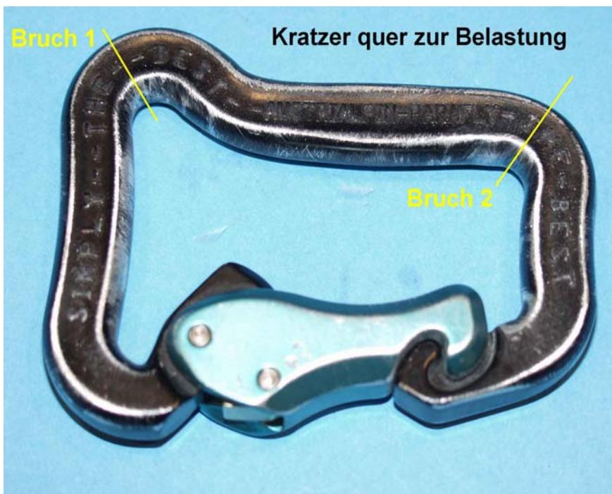
Bild 7: Foto der eingearbeiteten Kratzer und der aufgetretenen Bruchlagen
